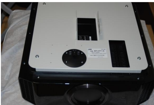
図 12 プロジェクターに、天吊り金具を取り付けたところ
