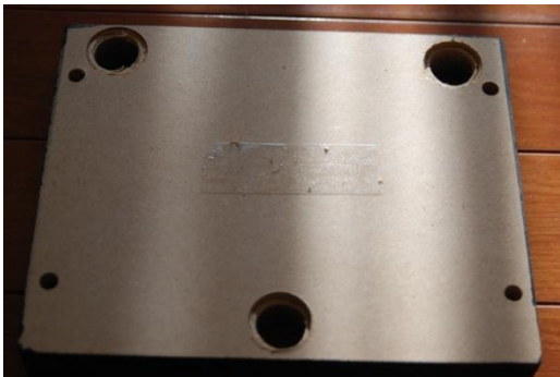
図 17 スペーサー部材 No.2 の穴を広げた
