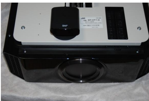
図 13 3D シンクロ・エミッターを取り付けてみたところ
